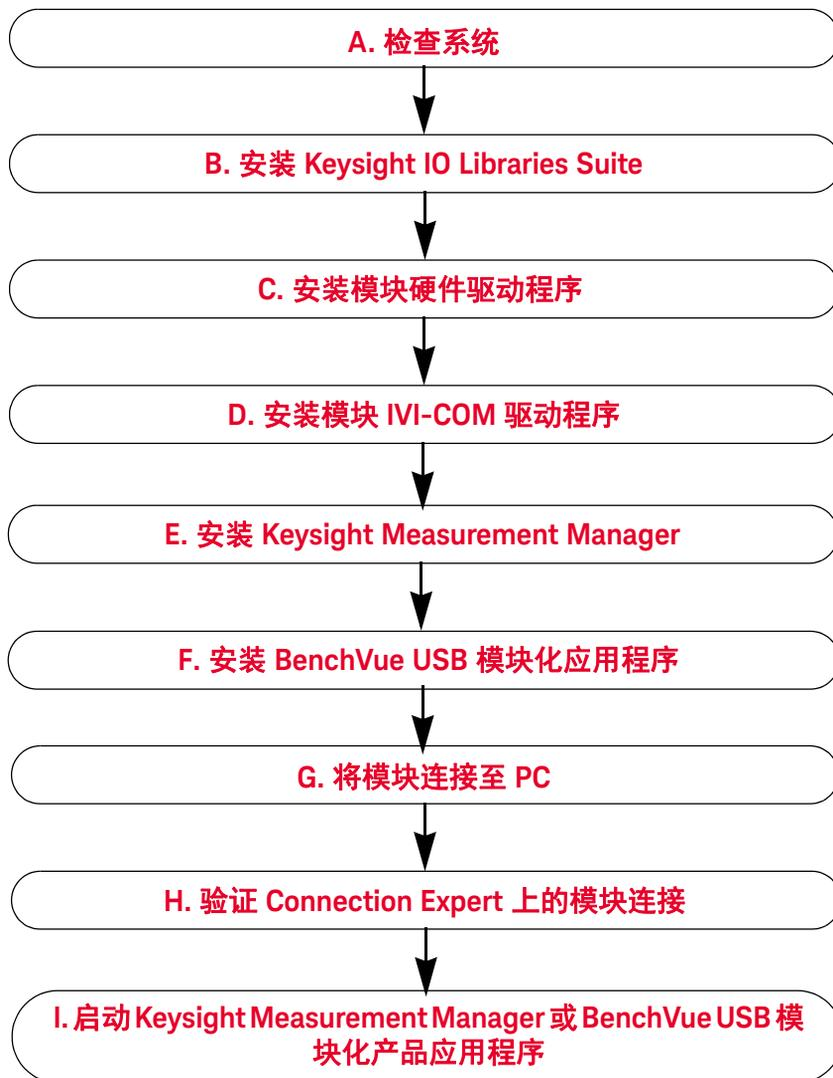
图 1-2 安装和配置流程图
